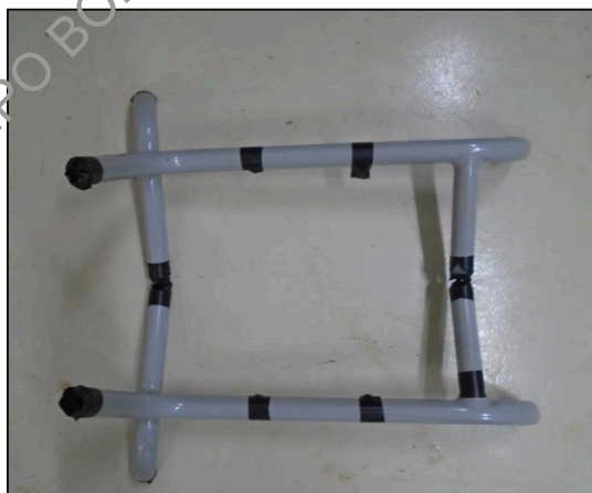
Foto 6 – Cadeira seccionada após o ensaio
