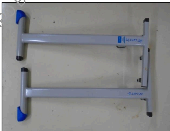
Foto 4 – Mesa seccionada após o ensaio
