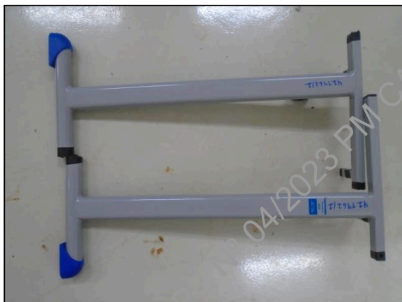
Foto 3 – Mesa seccionada antes do ensaio
